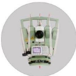
Il compensatore biassiale monitora l'inclinazione di entrambi gli assi, X e Y, e corregge l'angolo di lettura orizzontale e verticale automaticamente con un campo di azione di 3' DMS.
