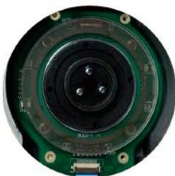
ARC 6 adotta un sistema di codifica angolare assoluta, che consente misurazioni stabili e precise con un'accuratezza di 2" DMS. I cerchi sono dotati di gusci di protezione dall'umidità dovuta alle diverse condizioni climatiche d'uso.
