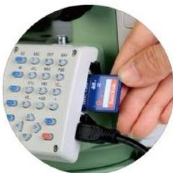
ARC 6 dispone di svariate opzioni per quanto riguarda il trasferimento dati, come l'SD Card, la porta USB e la porta seriale RS232.
