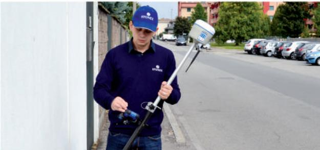
È molto facile misurare in angoli o spigoli. I sensori interni correggono le coordinate del punto acquisito in funzione dell'inclinazione angolare e di direzione.
