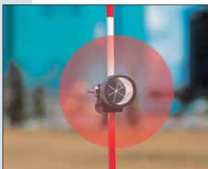
Per le misure con il prisma (P) viene emesso un raggio con ampiezza maggiore, adatto a stabilizzare la misura a grande distanza anche in presenza di riverbero nell'aria o in condizioni di collimazione critica.
